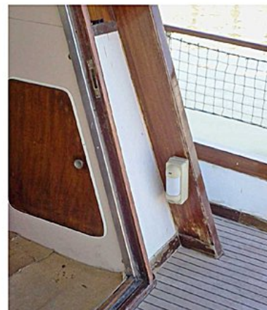
Rivelatore radio di movimento senza fili per ingresso poppa
